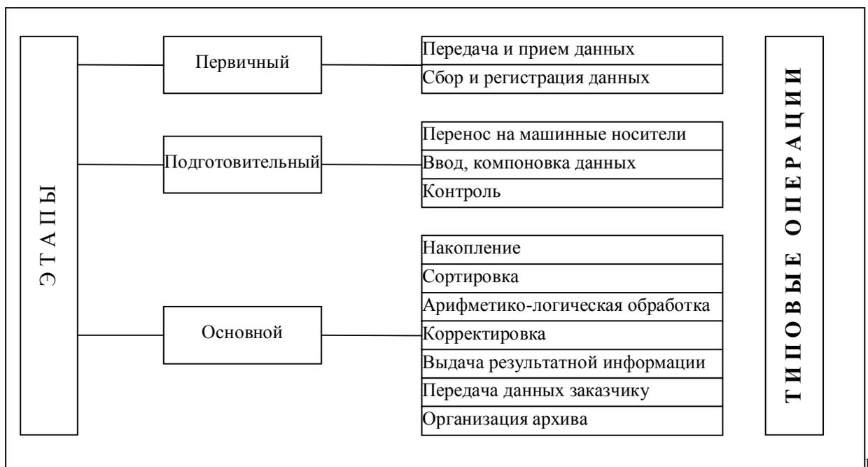
Рис. 1. Схема этапов и операций технологического процесса обработки данных.
